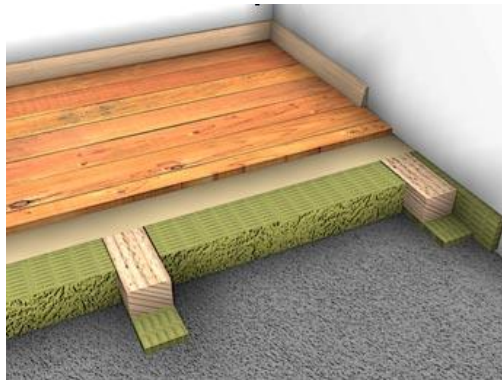
Slika 8 Primjer konstrukcije "plivajućeg" poda (Knauf Insulation, 2010.)
