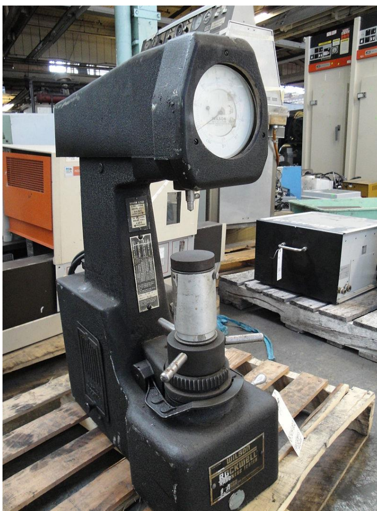
Slika 7. Uređaj za određivanje tvrdoće po Rockwellu ( https://hr.wikipedia.org/wiki/Tvrdo%C4%87a )
