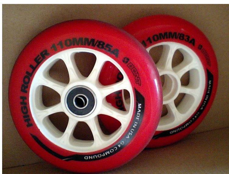
Slika 8. Dva kotača na dasci za koturanje s različitim tvrdoćama po Shoreu: 85A and 83A. ( https://hr.wikipedia.org/wiki/Tvrdo%C4%87a_po_Shoreu )
