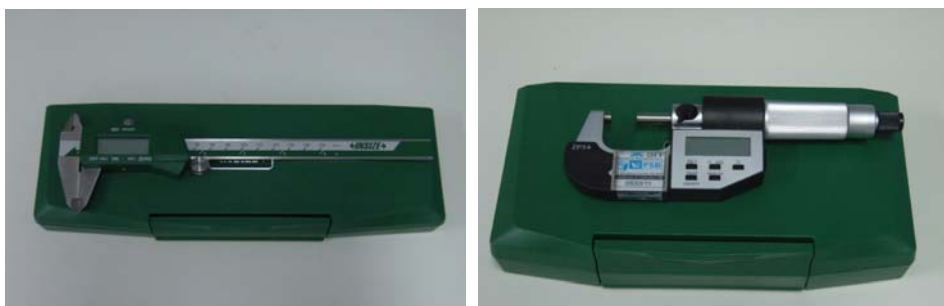
Slika 3. Digitalno pomično mjerilo i mikrometar
