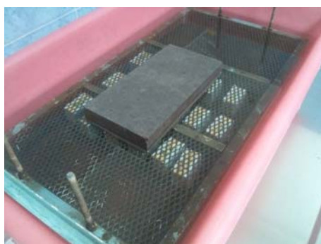
Slika 4. Tretman uzoraka u priručnoj vodenoj kupelji
