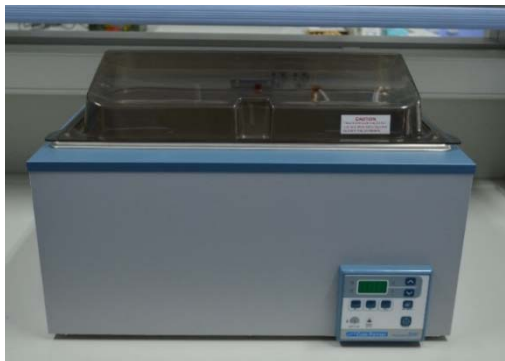
Slika 2. Laboratorijska vodena kupelj
