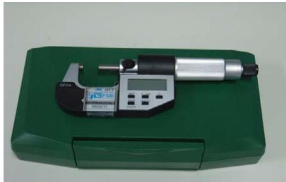
**Slika 4.** Digitalni mikrometar
