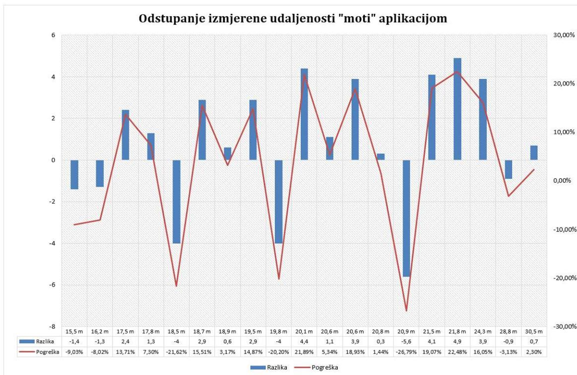
Slika 13. Grafički prikaz odstupanja (pogreške) u određivanju udaljenosti „moti“ aplikacije poredanih od najmanje do najveće udaljenosti.
