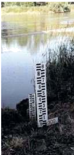
Slika 1 Vodomjerna letva za mjerenje vodostaja vodotoka i poplave vode (cm, m) (www.dhmz.hr)
