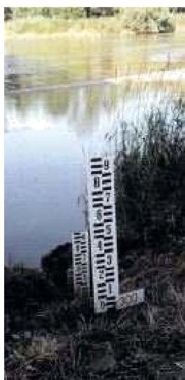
Slika 1 Vodomjerna letva za mjerjenje vodostaja vodotoka i poplave vode (cm, m) ([www.dhmz.hr](http://www.dhmz.hr))
