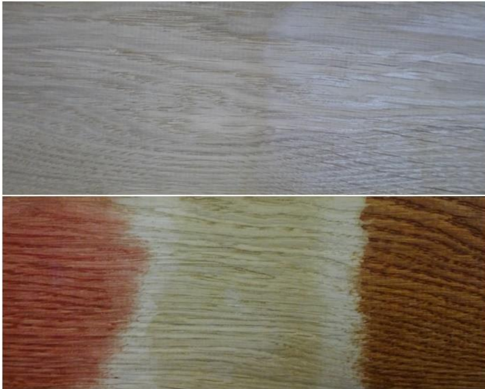
Slika 61. Uzorci hrastovine premazani uljem s pigmentima
