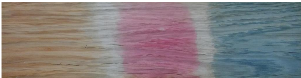
Slika 62. Uzorci hrastovine premazani pozitivnim bajcem
