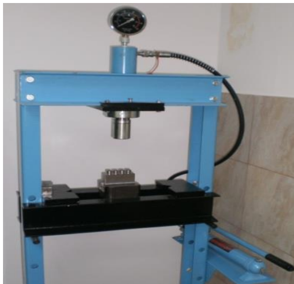
(slika 26.; hidraulična preša za izradu peleta, Augustinović, 2015)
