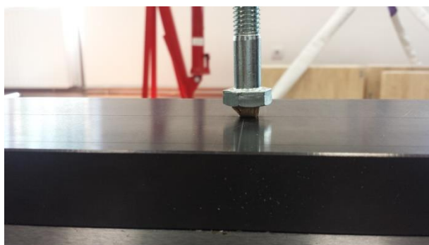
(slika 25.; mjerenje tlačne čvrstoće pomoću kidalice Shimadzu Autograph AG – X plus)
