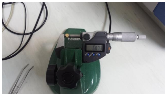
(slika 20.; mikrometar s postoljem)
