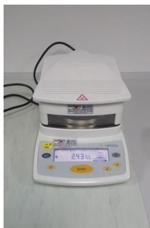
(slika 12.; IC analizator vlage sartorius MA 150 za određivanje sadržaja vode u drvu)
