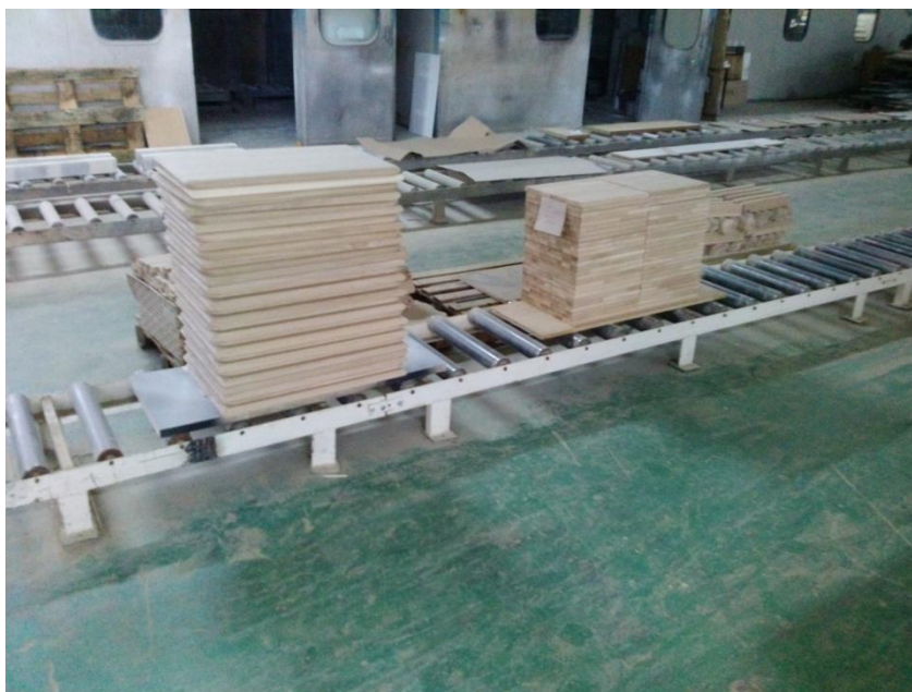
Slika 17. Transport obrađenih elemenata
