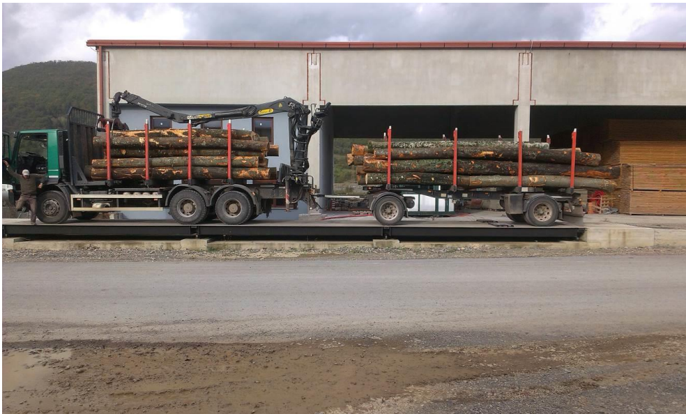
Slika 45. Kolna vaga za obavljanje kontrolnih mjerenja
