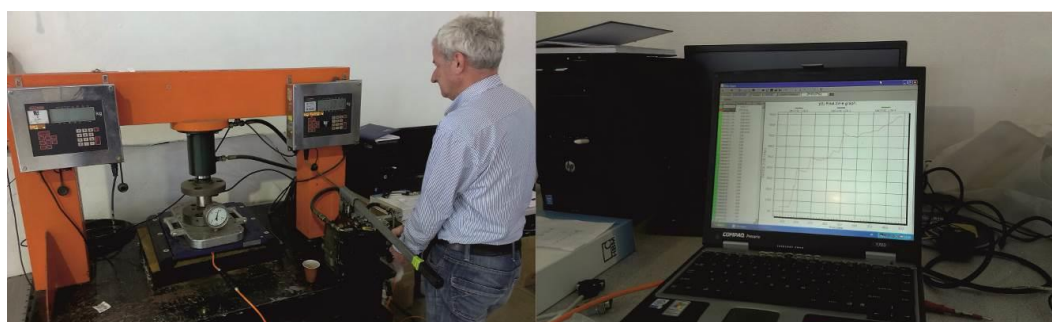
Slika 34. Umjeravanje prijenosnog mjernog sustava
