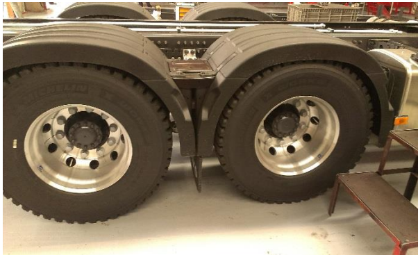
Slika 82. Opremanje kotača kamiona i prikolice aluminijskim naplaticima
