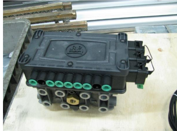
Slika 31. Osnovna jedinica EBS-a
