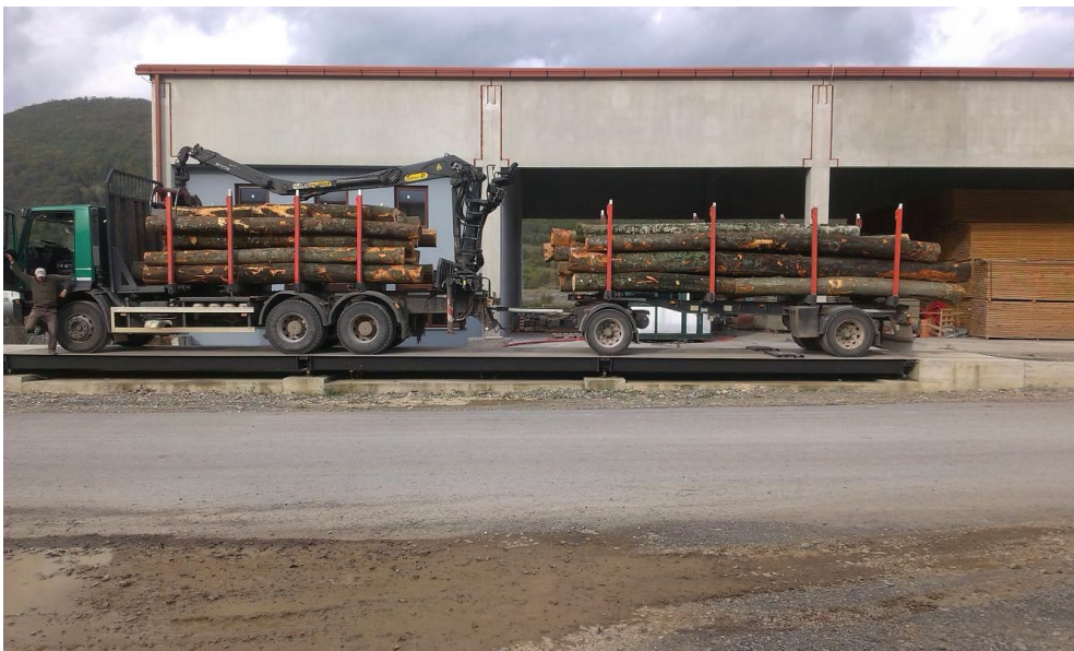
Slika 45. Kolna vaga za obavljanje kontrolnih mjerenja
