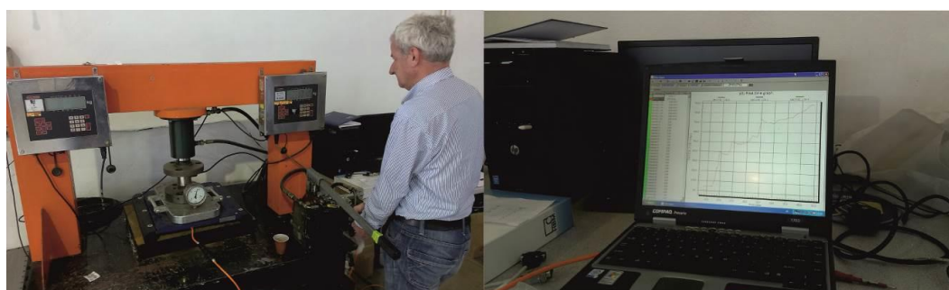
Slika 34. Umjeravanje prijenosnog mjernog sustava
