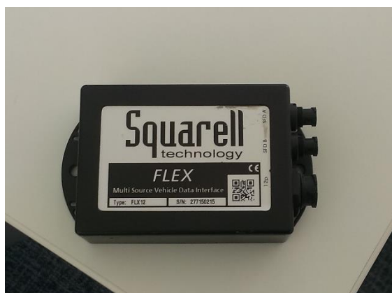
Slika 53. CAN modul korišten u istraživanju
