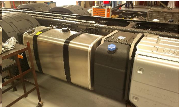
Slika 83. Opremanje kamiona aluminijskim spremnikom za gorivo
