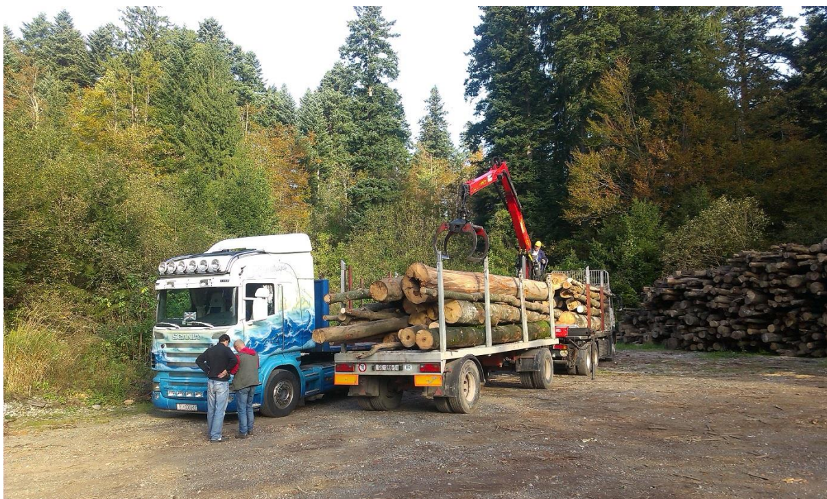
Slika 99. Utovar šumskog tegljačkog skupa na pomoćnom stovarištu uz javnu prometnicu
