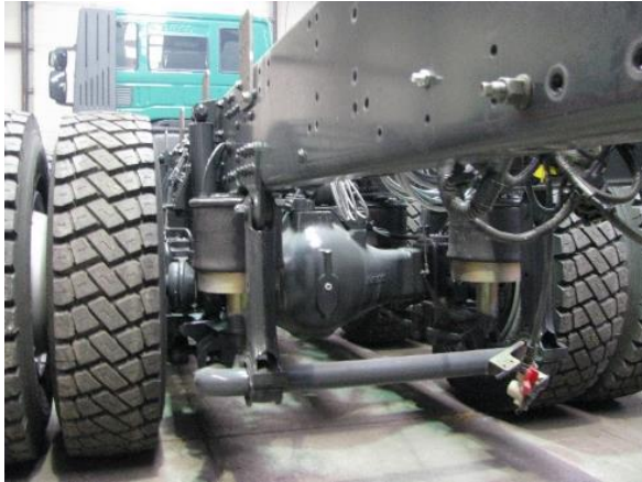
Slika 30. Zračni ovjes ŠKS
