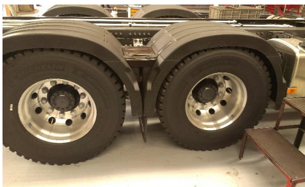
Slika 82. Opremanje kotača kamiona i prikolice aluminijskim naplaticima
