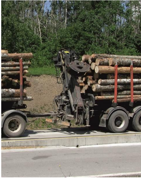
Slika 88. Transportni položaj dizalice
