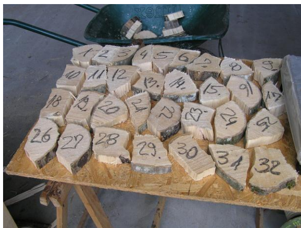
Slika 26. Uzorci iz cjepanica za potrebe mjerenja vlage gravimetrijskom metodom
