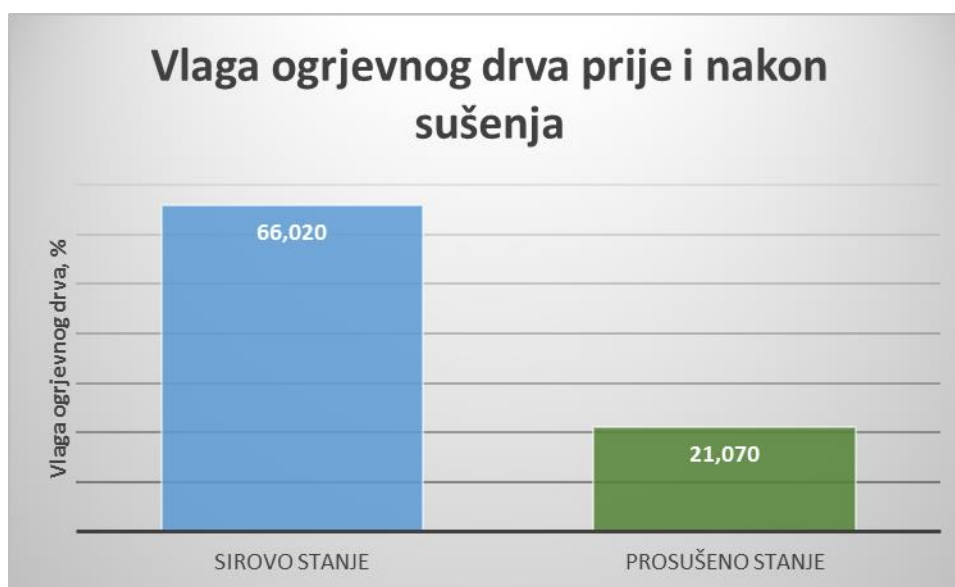
Slika 30. Grafički prikaz promjene sadržaja vlage ogrjevnog drva prije i nakon sušenja
