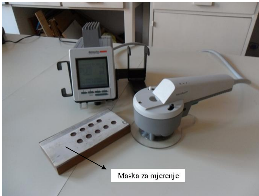
Slika 23. Spektralni fotometar Microflash 100d Datacolor
