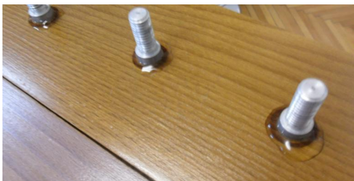
Slika 17. Prikaz zalijepljenog valjčića prilikom određivanja mokre adhezije
