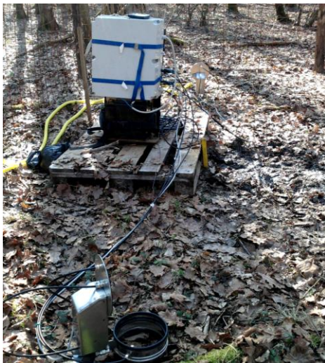
Slika 2.9. Sustav za izmjeru tok CO 2 iz tla postavljen u III dobnom razredu.
