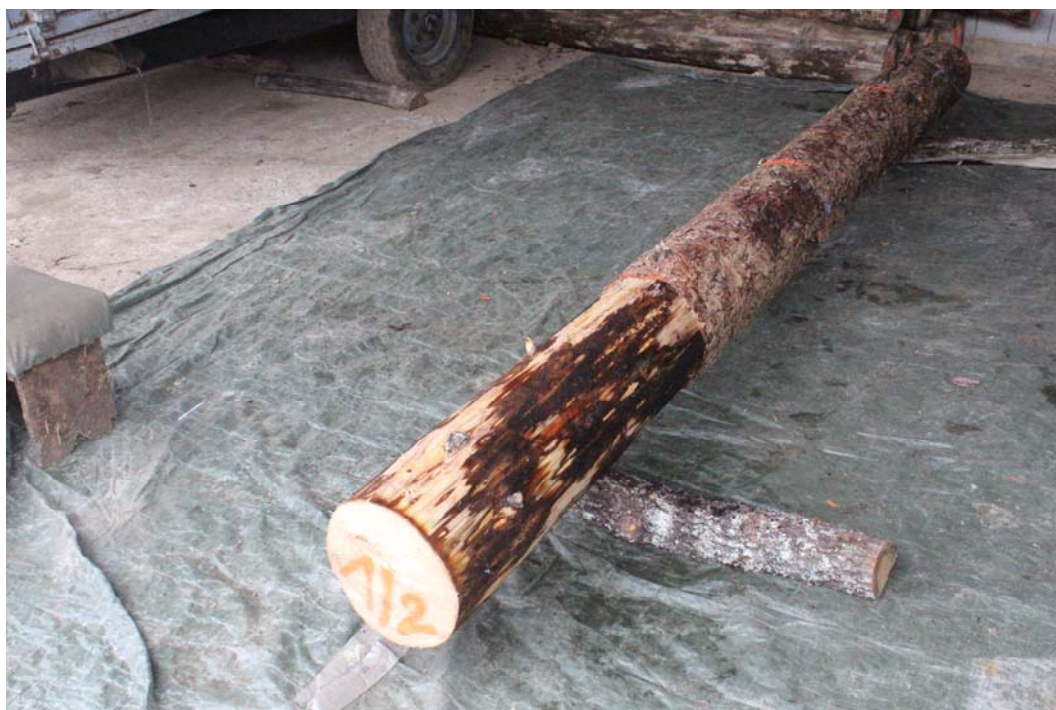
Slika 32. Otkorana sekcija duljine 1 m na 4 m dugačkom trupcu
