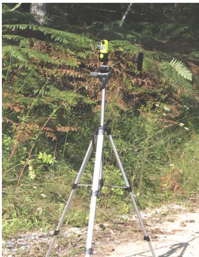
Slika 39. Anemometar Kestrel® 4300B proizvođača Nielsen-Kellerman® s vjetruljom na stativu
