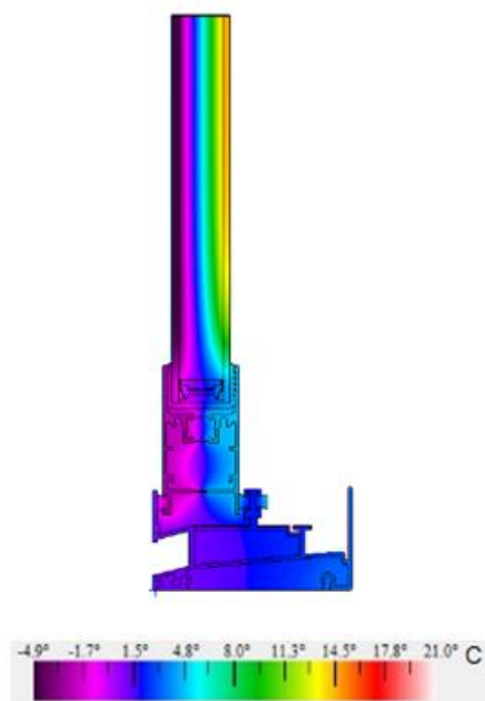
Slika 5. Toplinska polja u presjeku prozora s dvostrukim ostakljenjem (Horman i dr., 2002)
