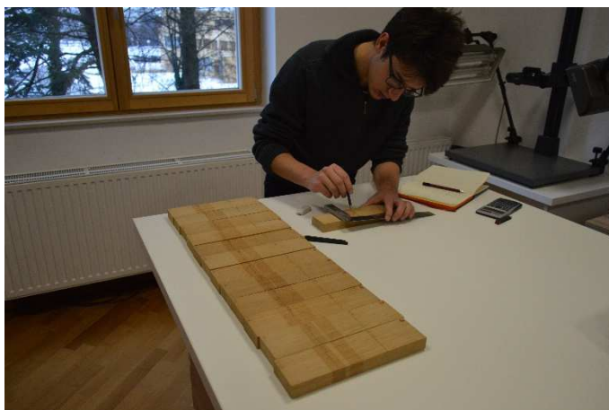
Slika 1. Označavanje uzoraka korištenih za ispitivanje sadržaja vode.
