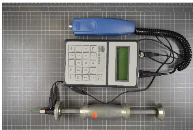
Slika 6. Elektrootporni vlagomjer GANN Hydromette M 4050.
