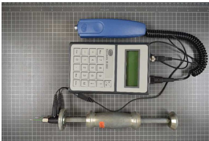
Slika 6. Elektrootporni vlagomjer GANN Hydromette M 4050 .
