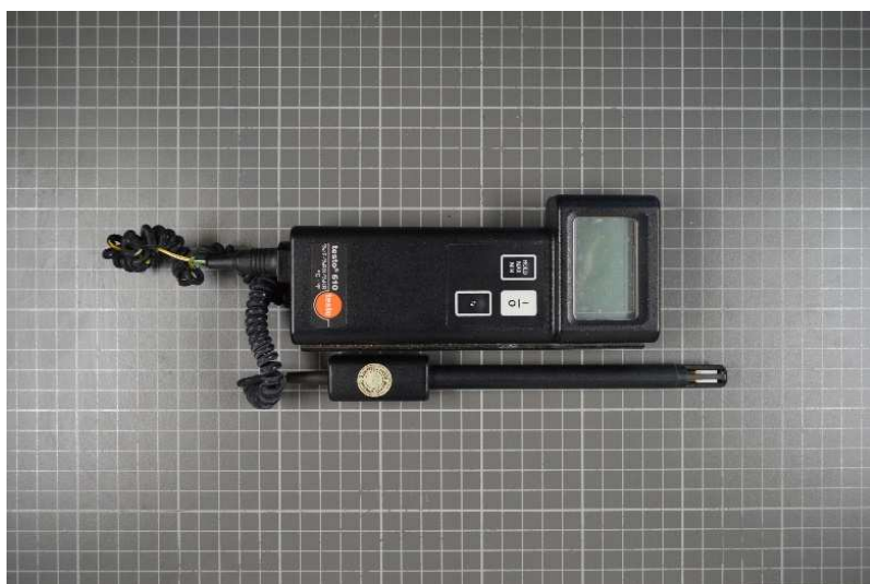
Slika 3. Uređaj za mjerenje temperature i relativnog sadržaja vlage u zraku Testo 610 .
