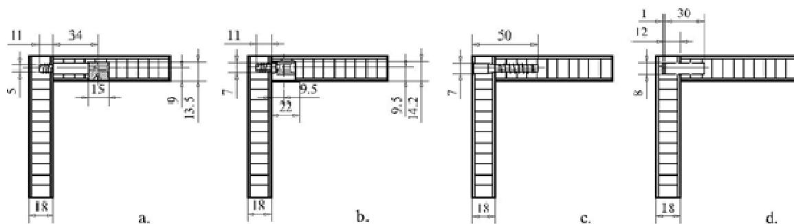
Slika 5. Prikaz vrste i dimenzije spoja sa spojnim elementima (Jivkov, 2002.).<sup>27</sup>
