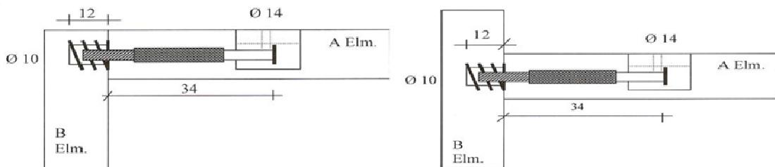
Slika 8. Kutno-plošni L- i T-sastavi povezani metalnim spojnim elementom "Minifix" (Kureli i Altinok, 2011.)<sup>34</sup>
