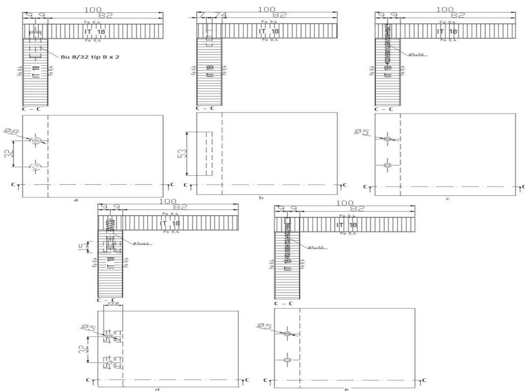
Slika 13. Prikaz uzoraka sastavljenih pomoću: a) moždanika, b) eliptičnog umetka, c) vijka za drvo, d) svornjaka sa zaokretnim klinom i e) "Confirmat" vijka (Župčić i suradnici, 2012.)<sup>39</sup>
