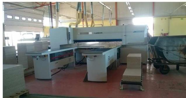
Slika 18. Formatna pila
