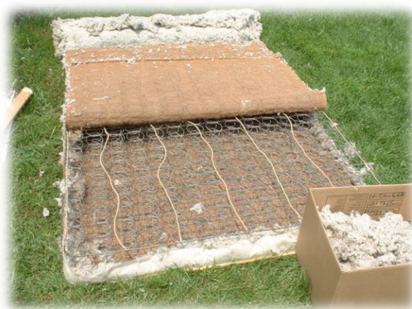
Slika 16. Opružna jezgra - primjer zastarjele konstrukcije madraca
