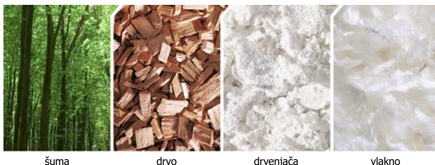
Slika 20. Tencel vlakno – prikaz dobivanja tencel vlakna
