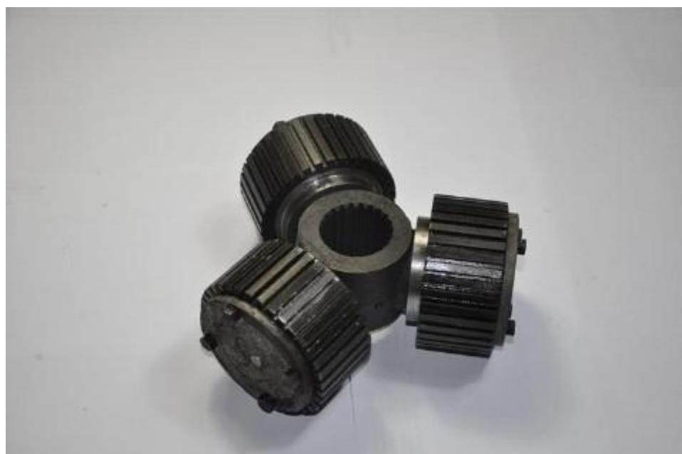
*Slika 24. Valjak od legiranog čelika*
