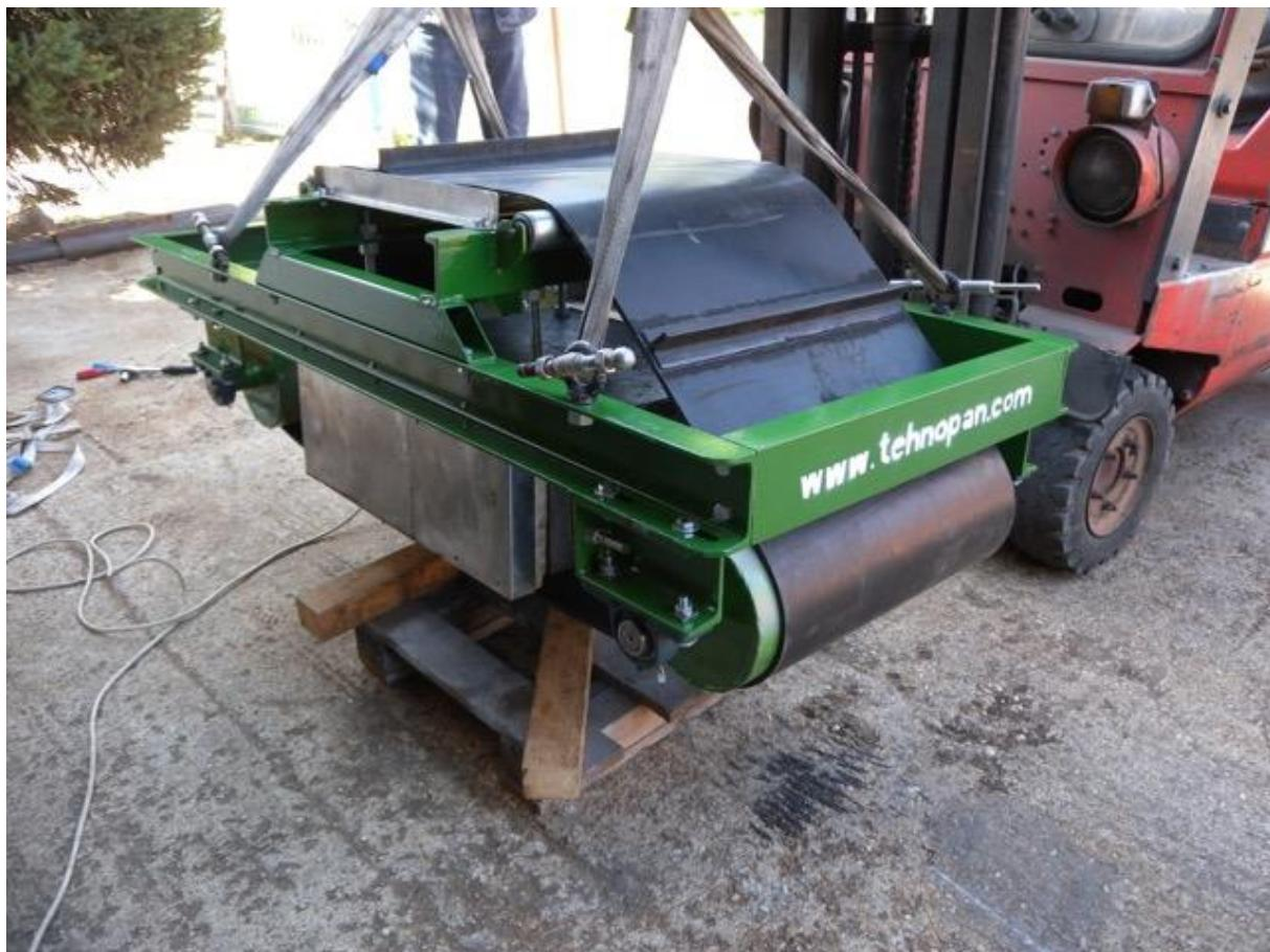
*Slika 16. TMS tračni magnetni separator*
