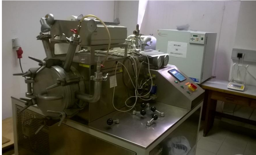
Slika 8. Uređaj za impregnaciju
