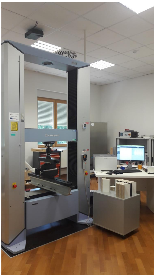
Slika 12. Kidalica shimadzu AG-X plus
