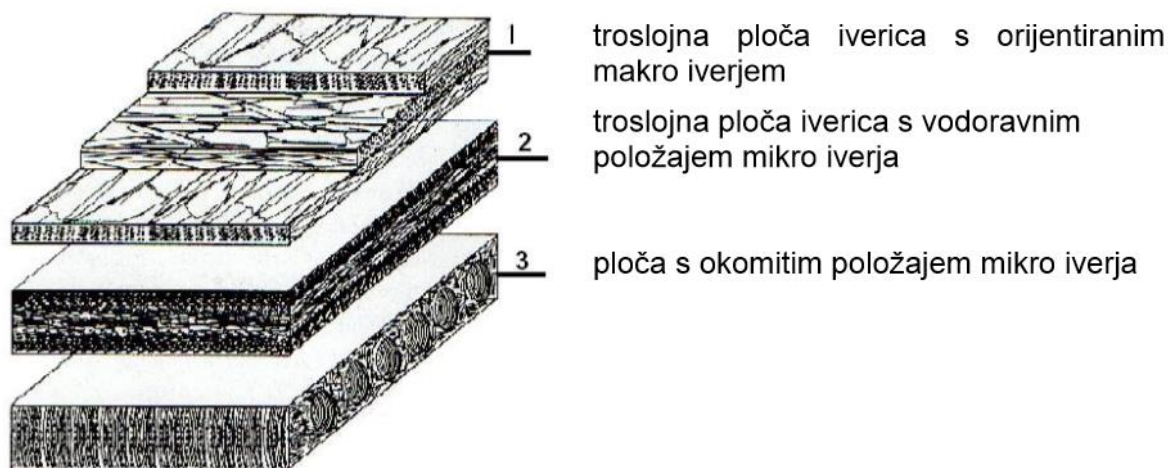
Slika 1. Sheme osnovnih vrsta ploča iverica (Jambreković, 2004.)
