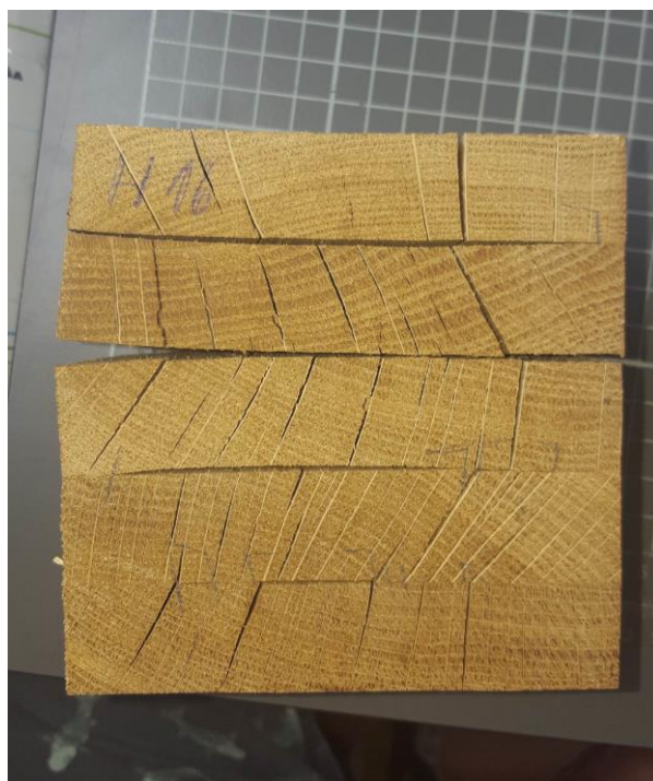
Slika 9. Ekstremna delaminacija H18
