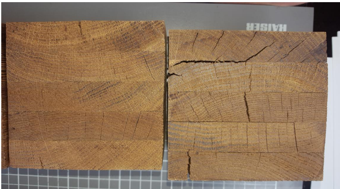
Slika 8. Velika razlika između uzoraka HT0 (lijevo) i HT 18 (desno)
