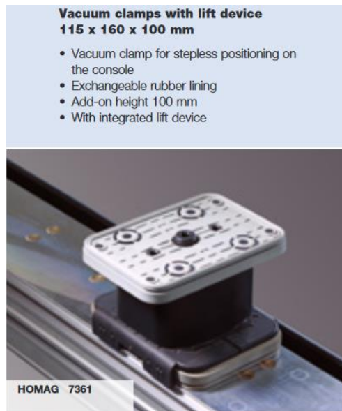
Slika 4. Homag 7361 usisna papuča koja dodaje dodatnih 100 mm prostora u smjeru Z osi ( https://www.homag.com/en/product-detail/bmq-500600-processing-centers/ )
