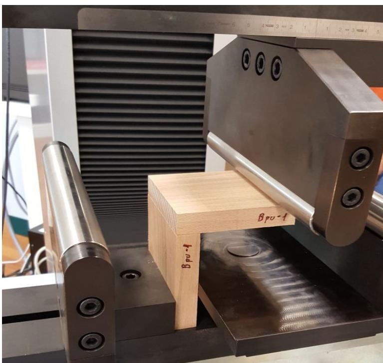
Slika 8. Položaj uzorka na kidalici
