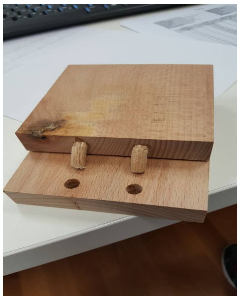
Slika 13. Potpuni lom i izvlačenje moždanika s minimalnom količinom nanosa ljepila
