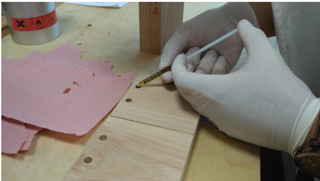
Slika 1. Nanošenje PUR ljepljiva
